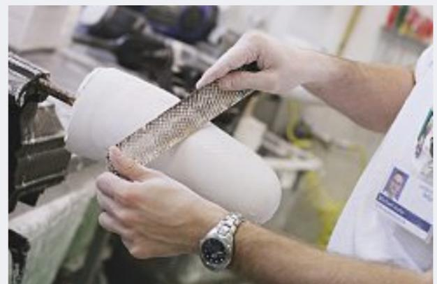
Aus der Gipshohlform wird ein Gipsmodell gegossen, das Michael Hofer hier mit einer Gipsraspel passend formt. Anschliessend erfolgt der Feinschliff mit Schleifpapier. Das Modell ist ein Abbild des Unterschenkelstumpfs.
